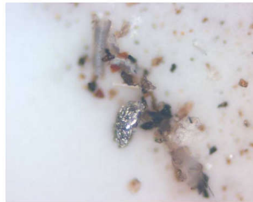
30 \mu\text{m} Partícula no ferrosa asociada a desgaste normal, muestra I.
