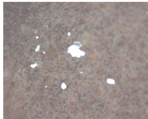
30 \mu\text{m} Partículas de antifricción asociado a un desgaste por fatiga en cojinetes, muestra O.
