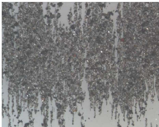
100 \mu\text{m} Alta concentración de partículas ferrosas, corrosión química, muestra I.
